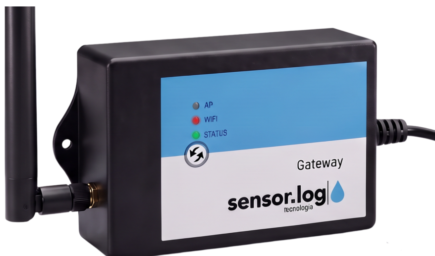
LEDs WiFi e STATUS acesos — conexão estabelecida
